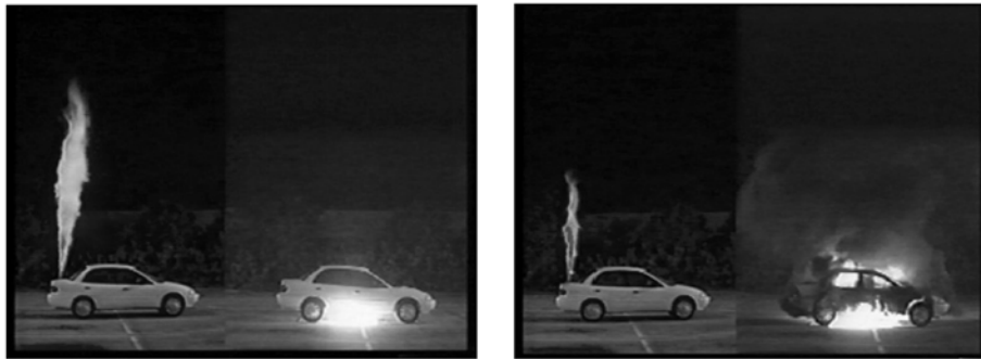
Figuur 5: Vergelijking van een brand met waterstof (linker wagen) en benzine (rechter wagen); Links: begin van de ontsteking; rechts na één minuut
